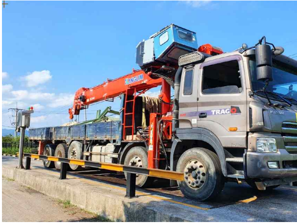
전하중계펌프장 세목스크린 4대 철거 이송 차량(7737) 계근 측정
